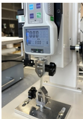
Рисунок 1. Образец пленки, подготовленный к испытанию на растяжение и разрыв с использованием испытательной машины ZP-500
