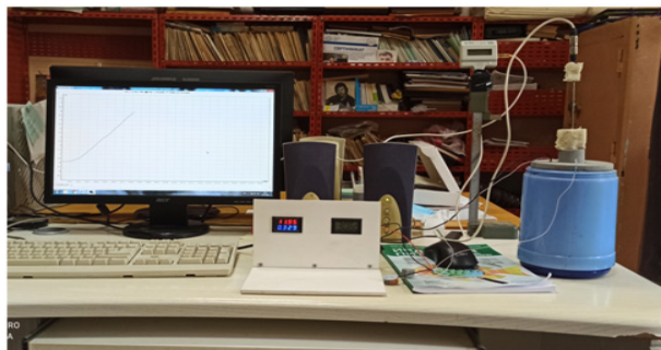
Рисунок 2. Опытный стенд для нахождения теплоемкости
